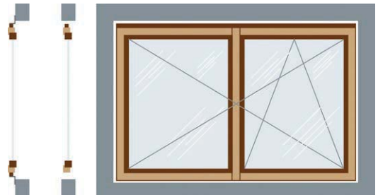
Bild 12. Fenster in Fassadenöffnung bzw. vor der Fassade [10]
