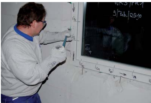
Bild 38. Manuelle Einbruchprüfung mit dem ca. 700 mm langen Kuhfuß [24]
