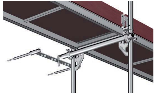
Bild 9. Schema eines demontierbaren „WDV Ankers“ (Wilhelm Layher GmbH & Co. KG)
