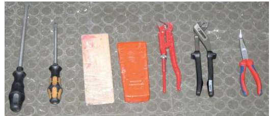
Bild 32. Im Rahmen der Widerstandsklasse WK 2 Prüfung verwendeter Werkzeugsatz [23]
