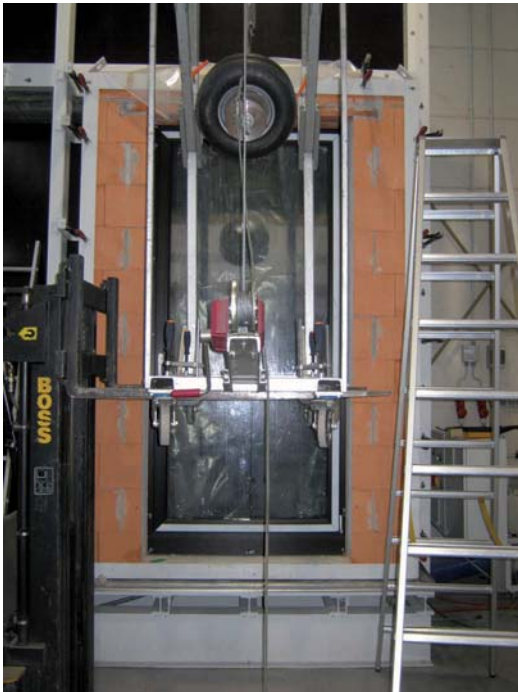
Bild 20. Simulation einer unplanmäßigen Nutzung mit einem Doppelreifenpendel [15]
