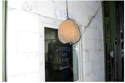
Bild 31. Dynamischer Versuch mit einem Sandsack (30 kg) [23]
